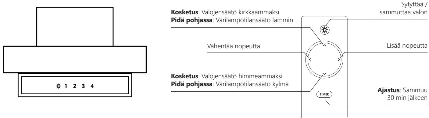
**1 2 3 4 Laitteen käynnistys / sammutus ja nopeuden säätö kytkinpaneelilipasta:** 1, 2, 3, tai 4. Nelosnopeus on intensiiviteho, joka palautuu aina kolmosnopeudelle 5 minuutin jälkeen. Laite voidaan myös sammuttaa / käynnistää käänämällä lippa auki tai kiinni laitteen alle.
