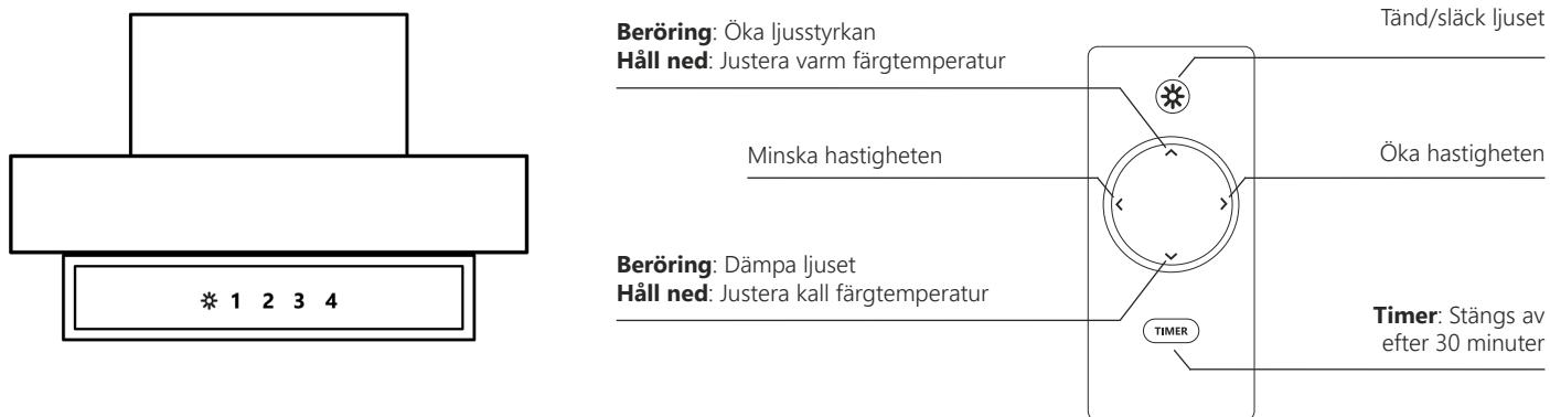
**1 2 3 4** **Starta/stoppa enheten och justera hastigheten från fliken på switchpanelen:** 1, 2, 3 eller 4. Fyra hastigheter är en intensiv kraft som alltid återgår till tre hastigheter efter 5 minuter. Enheten kan även stängas av/startas genom att öppna eller stänga locket under enheten.
